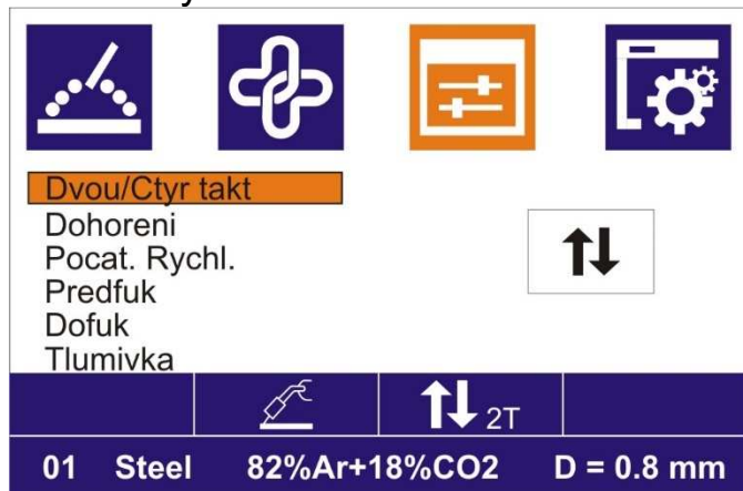
Obrázek 7. Nastavení sekundárních svař. parametrů
