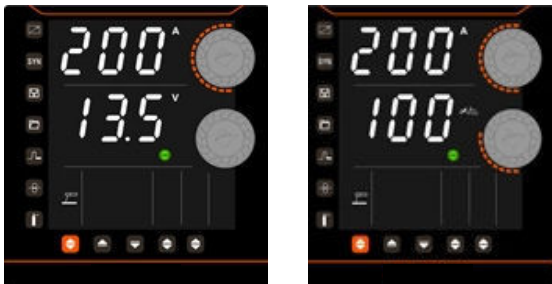
Obrázok 17: Nastavenia na ovládacom paneli: zvärací prúd MMA a ArcForce
