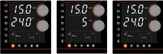
Obrázok 4: Nastavenie rýchlosti podávania drôtu a prúdu (napätia) a nastavenie indukčnosti (alebo času zapálenia drôtu)
