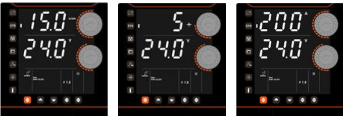
Obrázok 5: Synergické nastavenia zváracieho prúdu, rýchlosti podávania drôtu a hrúbky zváraného materiálu
