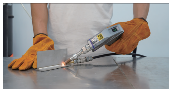
Zväracia hlava - "pištoľ" s vedením drôtu
