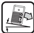
Přístroj vždy stavte jen na rovný, pevný a suchý podklad. Maximální dovolený úhel sklonu při instalaci činí 10°.
