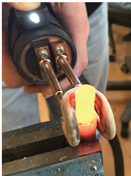
Indukční pájení měděných trubiček stříbrnou pájkou.
