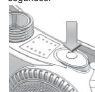
Pulse brevemente este botón para cambiar entre dos grados el flujo de aire de 160 l/min – 210 l/min. El modo de máxima circulación de aire proporciona un mayor nivel de protección para el usuario. Sin embargo a bajas temperaturas, el mayor caudal puede ser incómodo.
